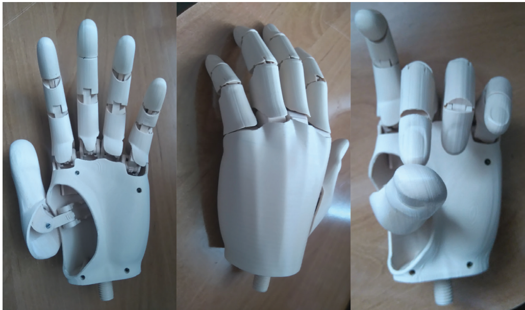
Rys. 17. Wydrukowana i złożona proteza ręki
