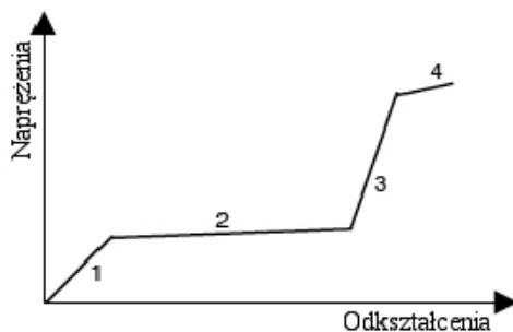
Ryc. 8. Krzywa rozciągania dla stopu o strukturze martenzytu
