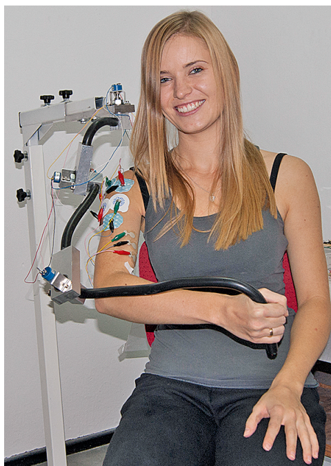
Rysunek 2. Zdjęcie przebiegu jednego z eksperymentów. W celu jednoczesnej rejestracji sygnału EMG oraz położenia kończyny górnej został wykonany prosty przestrzenny goniometr
