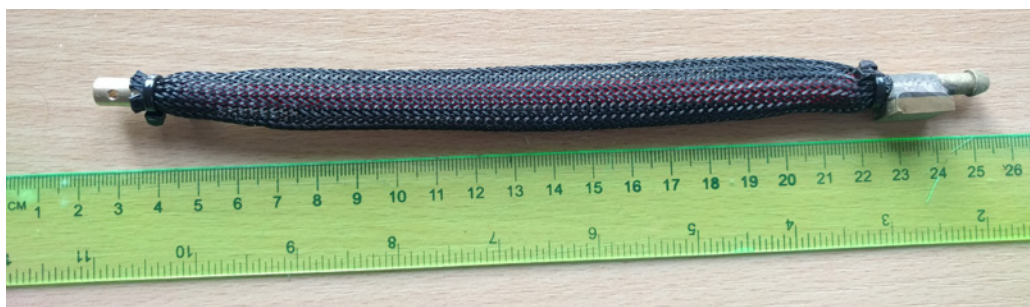
Rys. 3. Przykład jednego z opracowanych i wykonanych mięśni pneumatycznych
