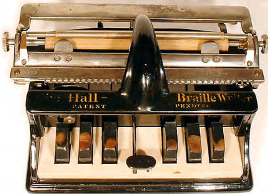
Rysunek 14. Hall Braille Writer z 1891 r.
