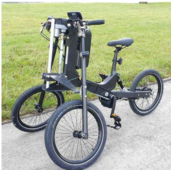
Rys. 8 Kompletny rower trójkołowy z mechanizmem zmiany rozstawu kół
