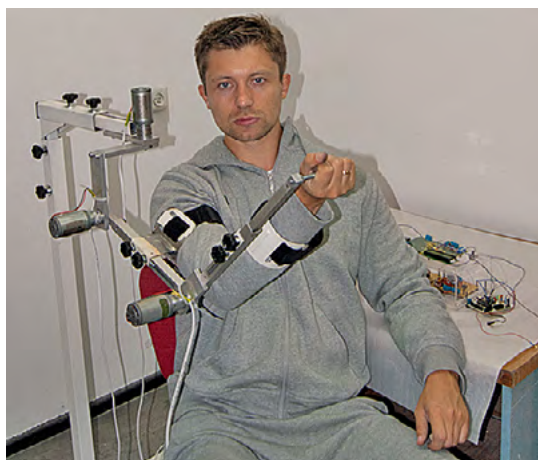
Rysunek 5. Robot SULRR ( Simple Upper Limb Rehabilitation Robot ), który również został zbudowany w ramach opisywanego projektu
