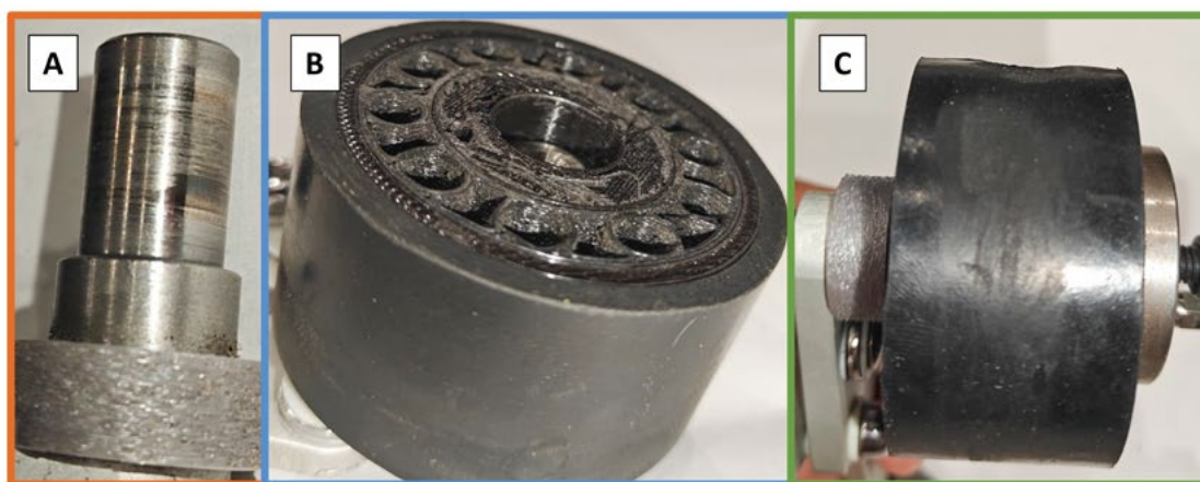
Ryc. 11. Zdjęcia zużyć wybranych elementów modułu blokady cofania po eksploatacji w warunkach rzeczywistych: A – zużycie osi centralnej, B – zużycie rdzenia sztywnego z ABS, C – zużycie bieżni z gumy EPDM (opracowanie własne)
