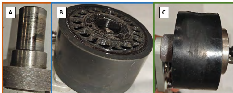
Ryc. 11. Zdjęcia zużytych wybranych elementów modułu blokady cofania po eksploatacji w warunkach rzeczywistych: A – zużycie osi centralnej, B – zużycie rdzenia sztywnego z ABS, C – zużycie bieżni z gumy EPDM (opracowanie własne)
