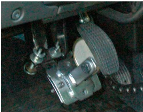
Fot. 3. KOD: 20.01 zmodyfikowany pedał hamulca Źródło: PIMOT
