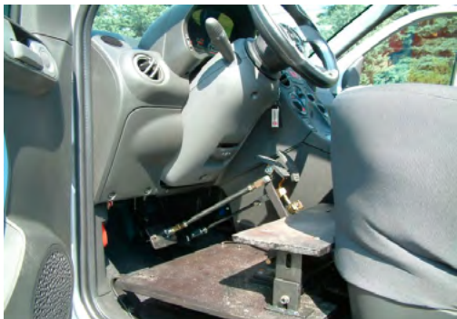
Fot. 7. KOD: 30.06, 30.10 wypiętrzona podłoga, podparcie nogi Źródło: PIMOT
