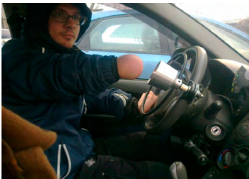
Fot. 14. KOD: 40.10 alternatywny system kierownicy Źródło: PIMOT
