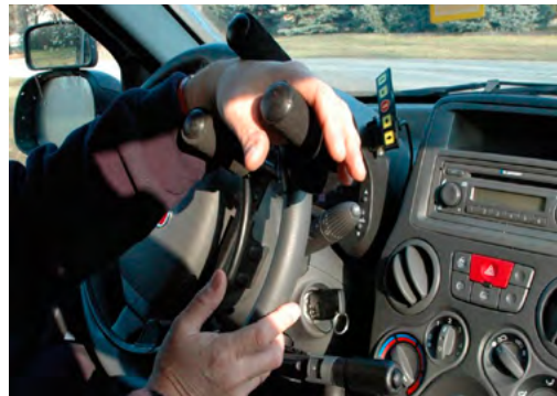
Fot. 15. KOD: 40.12 szyna ortopedyczna ręki na kole kierownicy (opcja) Źródło: PIMOT
