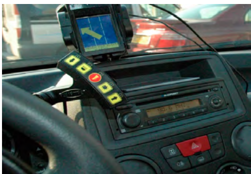
Fot. 9. KOD: 30.09 przegroda przed pedałami hamowania i przyspieszania KOD: 40.11 gałka na kierownicy Źródło: PIMOT
