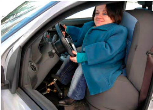
Fot. 12. KOD: 40.05, 43.01 zmodyfikowana kierownica, fotel kierowcy na dobrej wysokości obserwacyjnej Źródło: PIMOT
