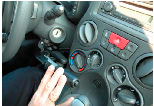
Fot. 2. KOD: 20.06 ręcznie sterowany hamulec roboczy (podkierownicowy) Źródło: PIMOT
