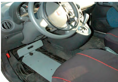
Fot. 9. KOD: 30.09 przegroda przed pedałami hamowania i przyspieszania KOD: 40.11 gałka na kierownicy Źródło: PIMOT
