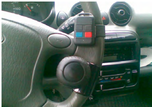
Fot. 8. KOD: 35.01 urządzenia sterowania obsługiwane bez negatywnego wpływu na kierowanie i obsługę (np. przełącznik świateł i kierunkowskazów w postaci bezprzewodowego pilota) Źródło: PIMOT
