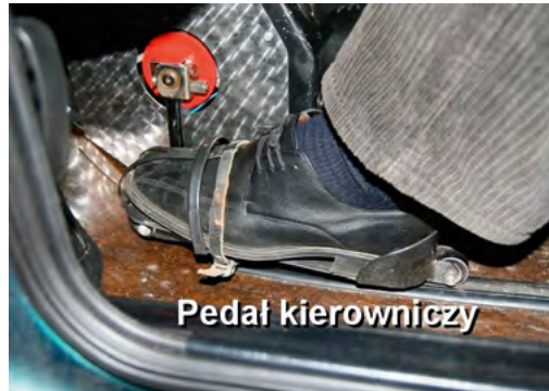
Fot. 13. KOD: 40.09 kierowanie nożne Źródło: PIMOT
