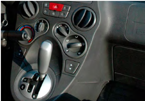
Fot. 1. KOD: 10.02 bez pedału sprzęgła (zautomatyzowana przekładnia biegów) Źródło: PIMOT
