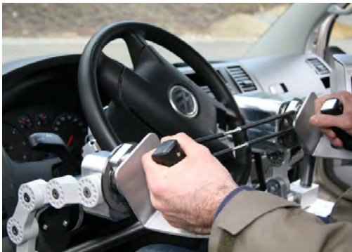
Fot. 14. KOD: 40.10 alternatywny system kierownicy Źródło: PIMOT
