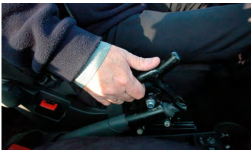
Fot. 5. KOD: 20.09 zmodyfikowany hamulec postojowy Źródło: PIMOT
