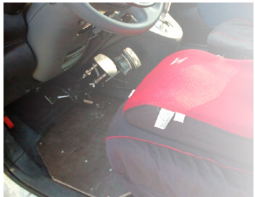
Fot. 4. KOD: 20.01 zmodyfikowany pedał hamulca Źródło: PIMOT
