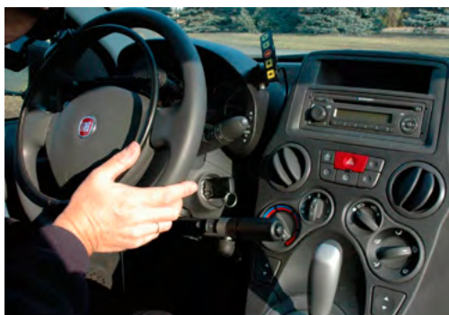
Fot. 10. KOD: 25.04 przyspieszenie sterowane ręcznie Źródło: PIMOT
