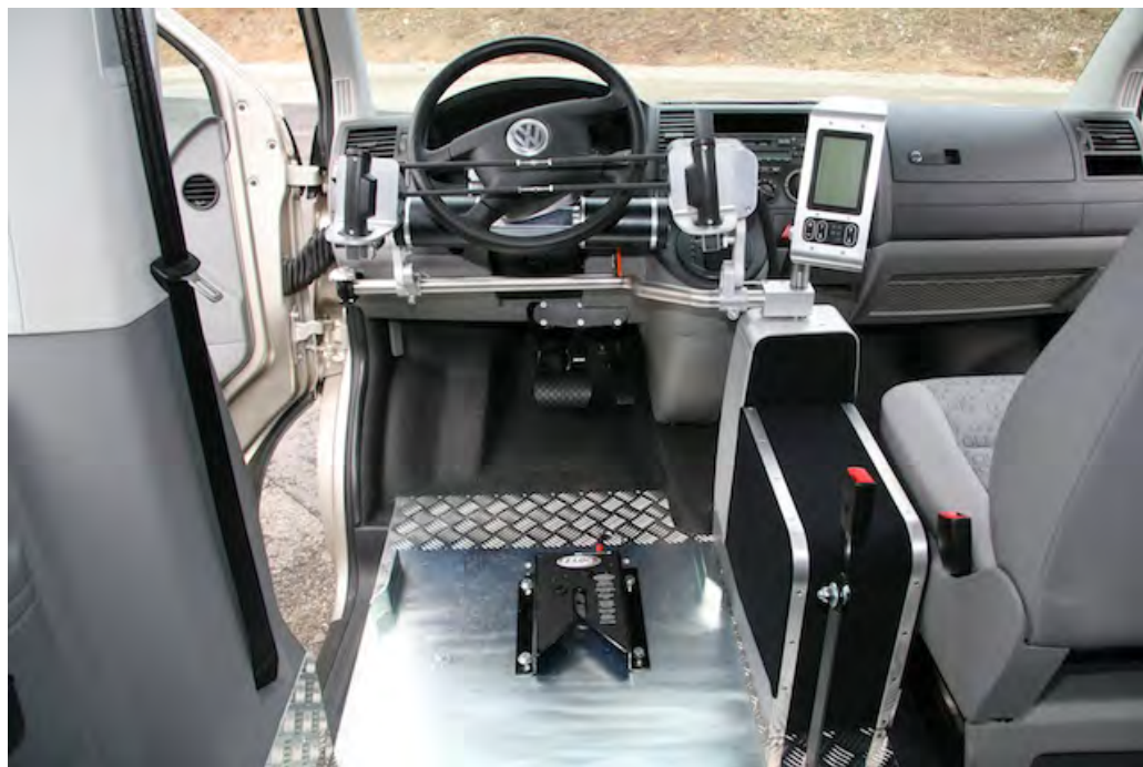
Fot. 20. Pojazd z systemem dokowania wózka inwalidzkiego, sterowany dżankami (kod: 40.10)
