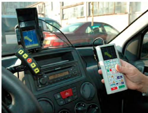
Fot. 18. Graficzny System Emisji Rozkazów dla niesłyszącego kandydata na kierowcę Źródło: PIMOT
