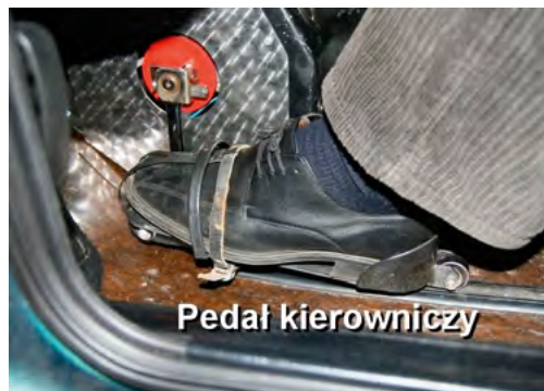
Fot. 13. KOD: 40.09 kierowanie nożne Źródło: PIMOT
