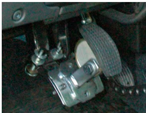
Fot. 3. KOD: 20.01 zmodyfikowany pedał hamulca Źródło: PIMOT
