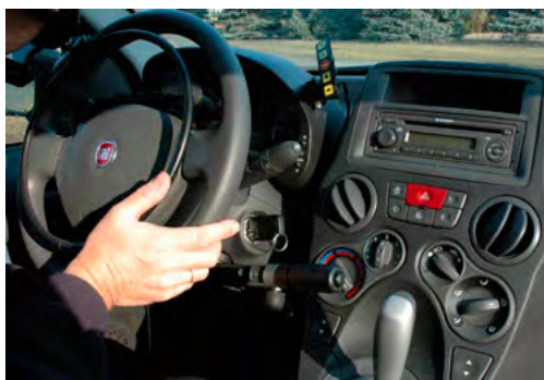
Fot. 10. KOD: 25.04 przyspieszenie sterowane ręcznie Źródło: PIMOT
