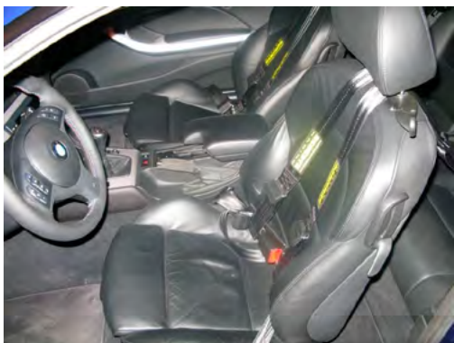
Fot. 17. KOD: 43.07 pas bezpieczeństwa szelkowy Źródło: PIMOT
