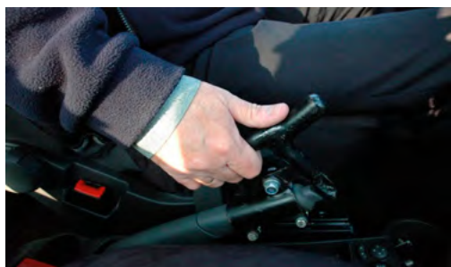
Fot. 5. KOD: 20.09 zmodyfikowany hamulec postojowy Źródło: PIMOT
