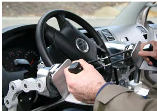
Fot. 14. KOD: 40.10 alternatywny system kierownicy Źródło: PIMOT
